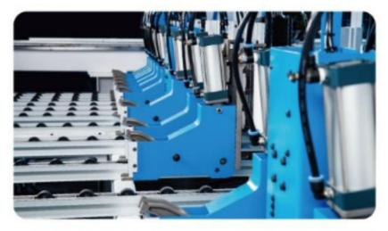
采用灵活的裹胶双指结构,最小夹板尺寸可实现 34×45mm。
